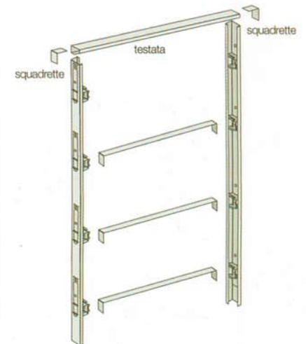
Falso telaio in Kit di assemblaggio
